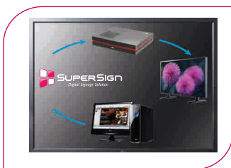
Controllo a distanza Per mezzo della rete LAN è possibile accendere o spegnere sia il display che il media player e aggiornare il software.
